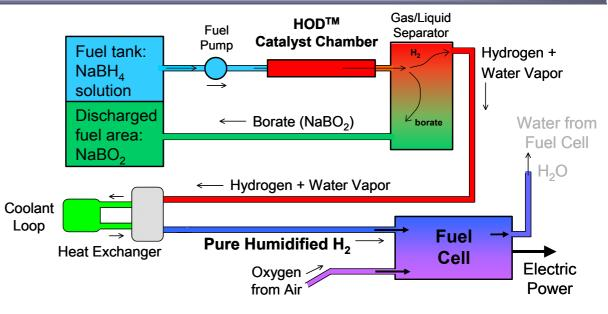
NaBH<sub>4</sub> + 2 H<sub>2</sub>O => NaBO<sub>2</sub> + 4 H<sub>2</sub>
